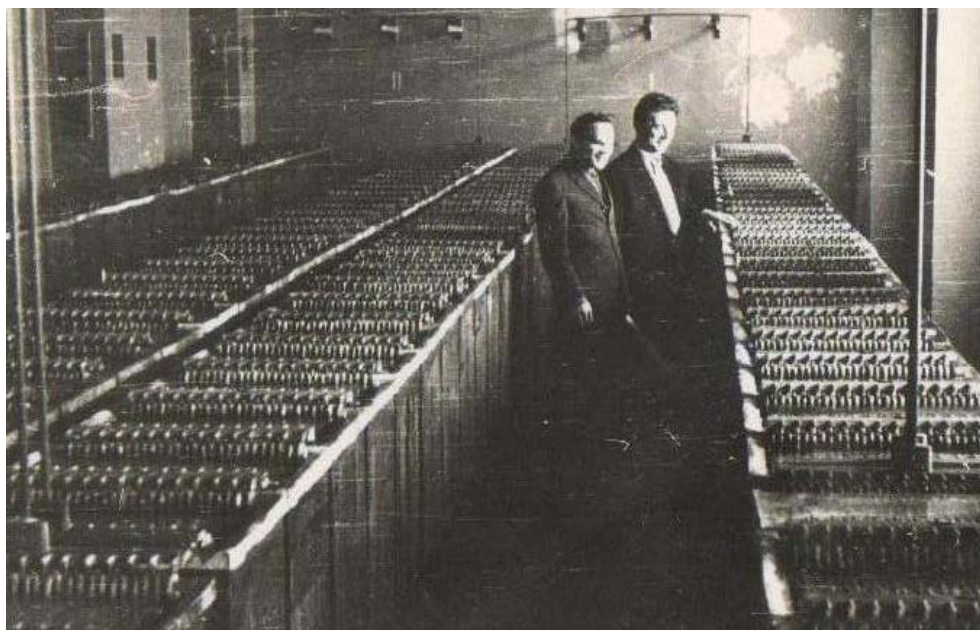
Одна из первых вычислительных машин Физфака. Релейная ВМ собственной комплектации. На фото: зав. Вычислительной лабораторией Физфака проф. В.Б. Гласко, сотрудник А. Граблев. 1970.
